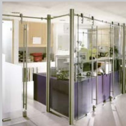
Türen, Treppengeländer, Trennwände, Ganzglasanlagen, usw. werden aus Sicherheitsgründen aus ESG hergestellt.
