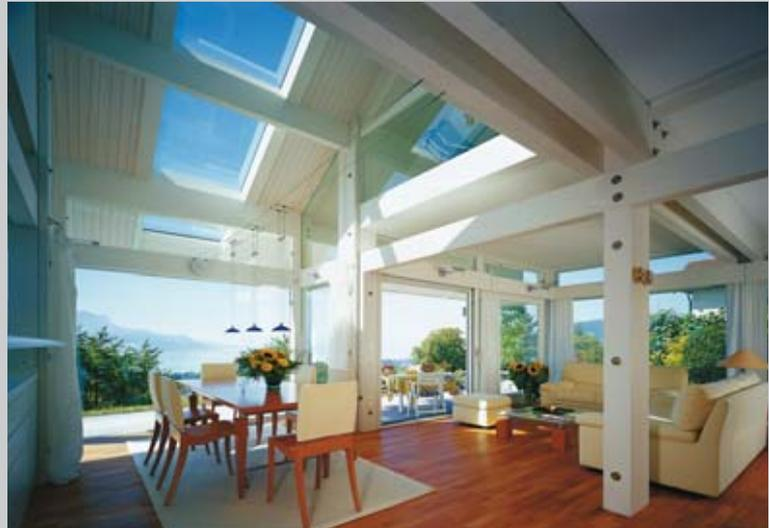
Schutz gegen Hagelschlag und herunterfallende Gegenstände. Die witterungsseitige Scheibe im Überkopfbereich wird in ESG ausgeführt.
